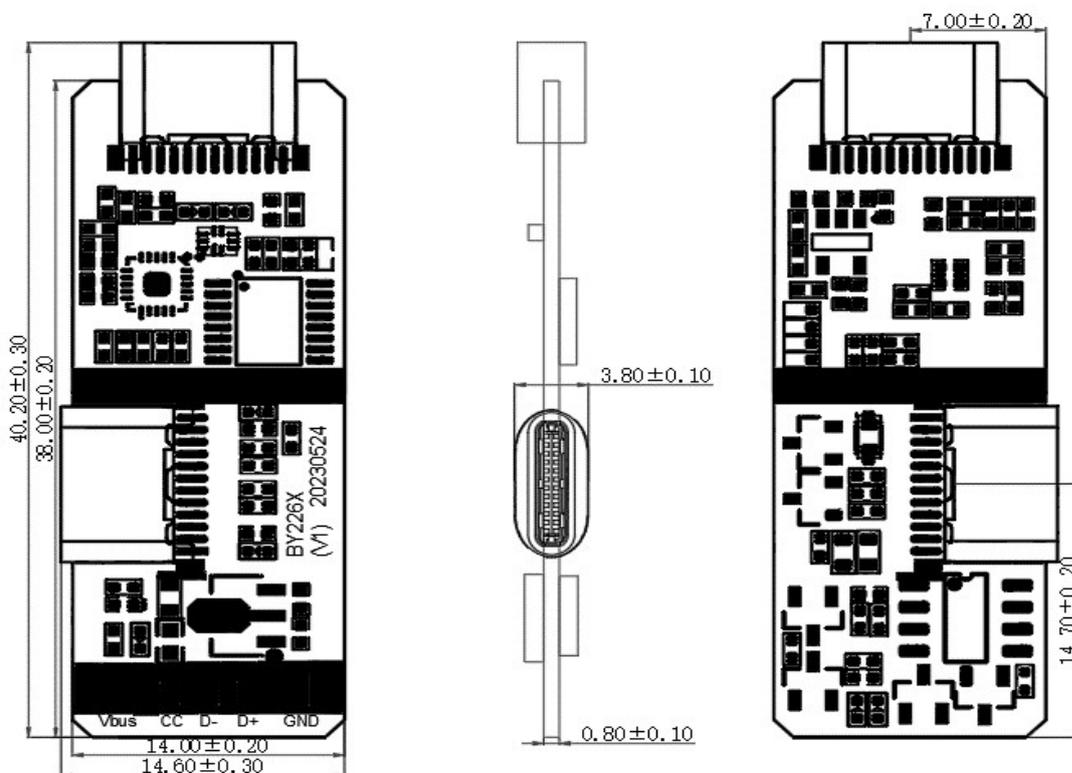
备注：标注的单位为mm（毫米）；除特别标注外，精度为±0.2mm。
