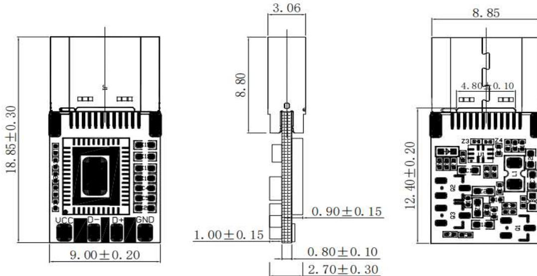
备注：标注的单位为mm（毫米）；除特别标注外，精度为 $\pm 0.2$ mm。
